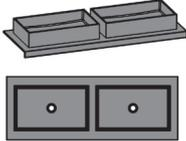
Becken freistehend<br><b>ohne</b> Armaturbohrungen<br>und Überlauf |                    |  |
