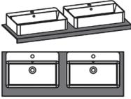
Wandanschluss<br><b>mit</b> Armaturbohrungen<br>und Überlauf |                    | Waschtisch<br><b>Mineralstein</b><br><br>Aufsatzbecken<br><b>Keramik</b><br><br>
