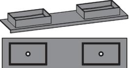
Becken freistehend<br><b>ohne</b> Armaturbohrungen<br>und Überlauf |               |  |
